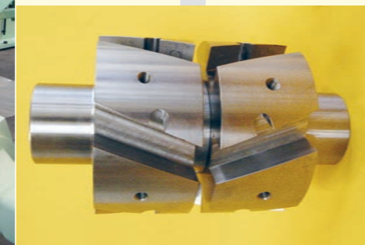
Nachschleifdorn mit Messerhalter und Schneidmessern Regrinding shaft with tool holder and cutters
