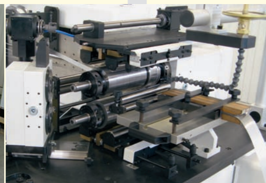
Scherenkopf mit Stahlauswerfvorrichtung Slitting head with steel stripper ring unit
