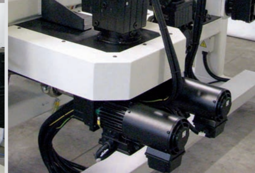
Individuelle Antriebe mit einzeln umschaltbaren Wickelrichtungen Individual drives with changeable recoiling directions
