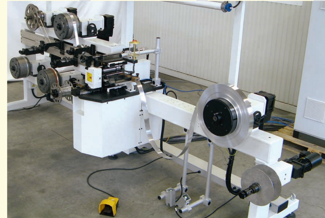
Modular aufgebaute Anlage zum freien Aufstellen auf Nivellierfüßen ohne Fundamentarbeiten und Montagekosten Modular based slitting line set on levelling feet without any investments in foundation and installation work
