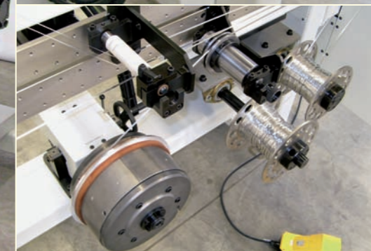
Zwei unabhängige Besäumstreifenwickler Variabel verstellbare Bandführungen ohne Kompromisse Two independent scrap winders Unlimited variably adjustable strip guides
