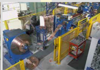
Совершенные системы намотки для производства тонких лент с гарантированно ровными краями, плотно смотанными рулонами
