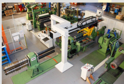
Совершенные системы намотки для производства тонких лент с гарантированно ровными краями, плотно смотанными рулонами
