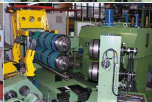
Kreismesserscheren für präzise Schnittqualität mit automatischen Werkzeugwechsel- und Spannsystemen Дисковые ножницы для прецизионной резки металла с автоматическим устройством для смены инструмента и устройства для натяжки ленты
