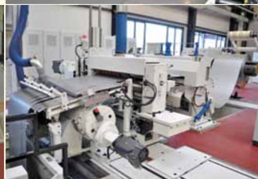
Kreismesserscheren für präzise Schnittqualität mit automatischen Werkzeugwechsel- und Spannsystemen Дисковые ножницы для прецизионной резки металла с автоматическим устройством для смены инструмента и устройства для натяжки ленты
