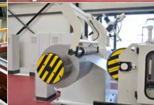
⌘ Korrekte Werkzeuglagerung ⌘ Aufwickleinheit für garantiert kantengerade, satt gewickelte Bunde ⌘ Правильное хранение инструмента ⌘ Узел перемотки для плотно намотанных бунтов с определено прямой кромкой
