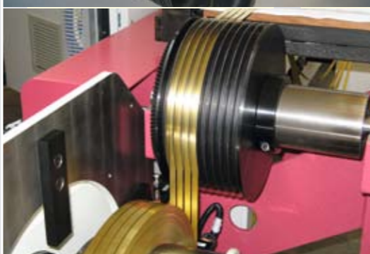
Dünmbandwickelsystem: Wickeln mit konstantem Aufwickelwinkel Thin gauge recoiling system: Rewinding with constant recoiling angle
