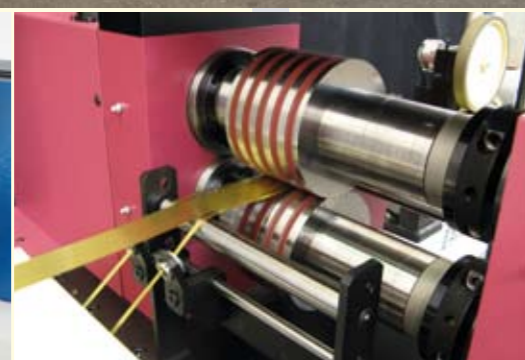
Schneiden mit Gummiauswerferringen Cutting by using rubber stripper rings
