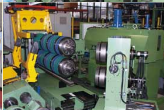
Kreismesserscheren für präzise Schnittqualität mit automatischen Werkzeugwechsel- und Spannsystemen Slitter for advanced cutting quality assisted by automatic tool loading station and clamping units
