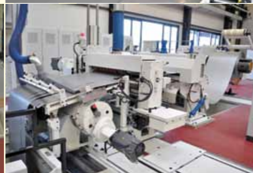
Kreismesserscheren für präzise Schnittqualität mit automatischen Werkzeugwechsel- und Spannsystemen Slitter for advanced cutting quality assisted by automatic tool loading station and clamping units
