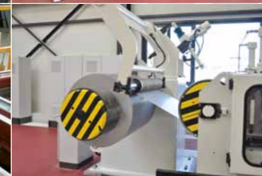
⌘ Korrekte Werkzeuglagerung ⌘ Aufwickleinheit für garantiert kantengerade, satt gewickelte Bunde ⌘ Master tool storage ⌘ Recoiling system for guaranteed uniform, tight coils
