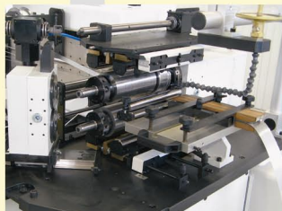
Testa di taglio con dispositivo d'espulsione tramite anelli d'acciaio
