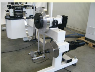
Aspo svolgitor predisposto per funzionamento ad ansa e tiro diretto con avvolgitore per carta
